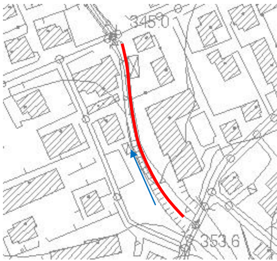
Argine in destra idrografica da riposizionare in quota
