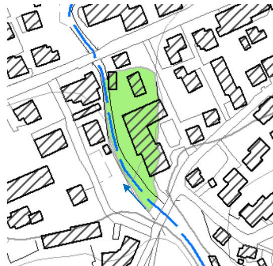
Area depressa potenzialmente soggetta ad allagamento
